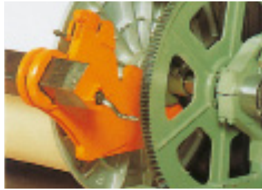
Höhenverstellbare Rohrgreifern z.B. im Fall von Universallagerung Tube grippers adjustable in height, e.g. in case of universal bearing
