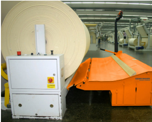
Einhängen mit Überrollklappe Hang on with overroll flap
